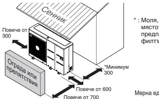
\* : Моля, обезопасете мястото на монтаж на предпазния клапан и филтъра.
