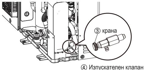
**Етап2.** За да източите останалата вода от продукта, отворете крана(③) на изпускателния клапан(④) обратно на часовниковата стрелка. След източване го затворете в обратна посока до края.
