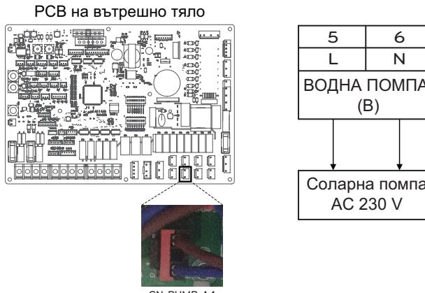
\* Номерът за свързване на клемния блок може да се различава в зависимост от модела.
