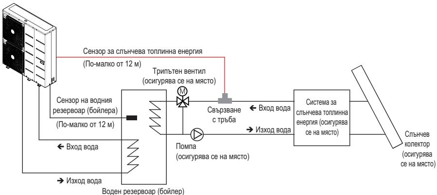
\* Схемата за инсталациране на Вход / Изход за вода може да варира в зависимост от модела.
