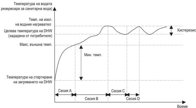
Сесия A: загряване от компресорния цикъл на ТПВВ и водния нагревател
