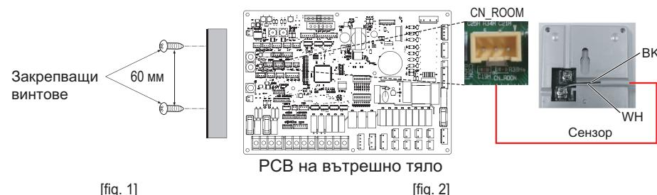
**Стъпка 6.** Закачете дистанционния датчик за температура на винтовете, като спазвате посочената на фигурата последователност.
