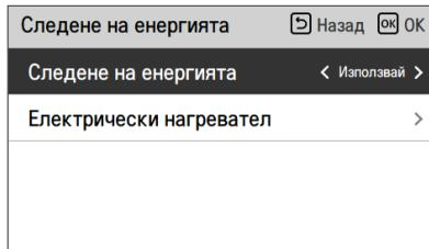
Ако се използва нагревателят на устройството, мощността на нагревателя може да се изчисли след задаване на информацията за нагревателя на дистанционното управление.
