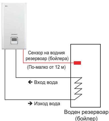
\* Схемата за инсталлиране на Вход / Изход за вода може да варира в зависимост от модела.
